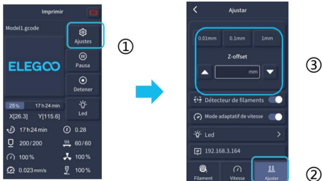
**REMARQUE :** Lors de l'impression et en suivant cette procédure pour régler la hauteur de la buse, assurez-vous que vous passez la distance de déplacement aux paramètres d'incrément plus petits de 0,01 mm ou 0,1 mm pour éviter que la buse ne glisse excessivement le long de la plateforme du lit chauffant (ce qui peut endommager la plaque de construction) ou empêcher le filament de rester en suspension dans l'air.
